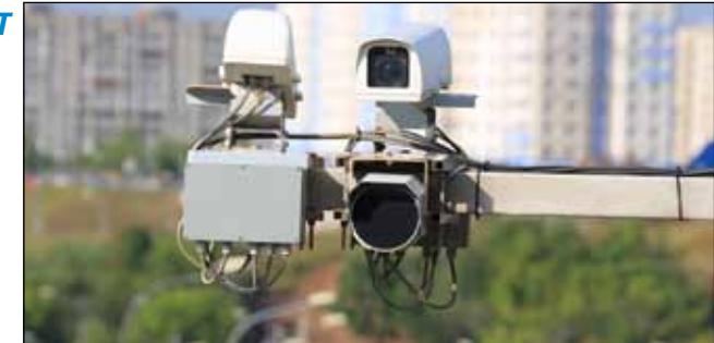
вания компания «ТБДД» внедрила возможность настройки длительности записи видеороликов. Таким образом, в зависимости от региональных требований видеоролик может иметь разную продолжительность, например, фиксируя всю fazu красного сигнала светофора либо часть фазы, содержащую момент нарушения ПДД.
